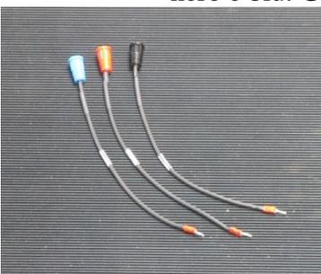
**CAVO #6** NO. 1 Adattatore. E' lungo 15 cm e terminato su entrambi i capi con connettori di sicurezza a banana da 4mm. L'adattatore è marcato con l'etichetta "7".
